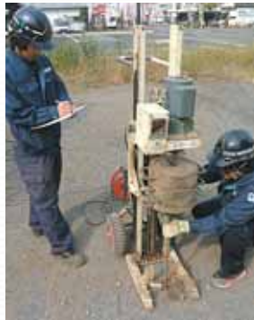
800mmのロッド先端にスクリューポイントを取り付け、100kgの荷重をかけ、地中に入ることによって抵抗を測定する地盤調査です。
